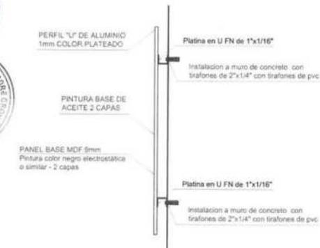
**DETALLE DE ANCLAJE EN EL MURO**
