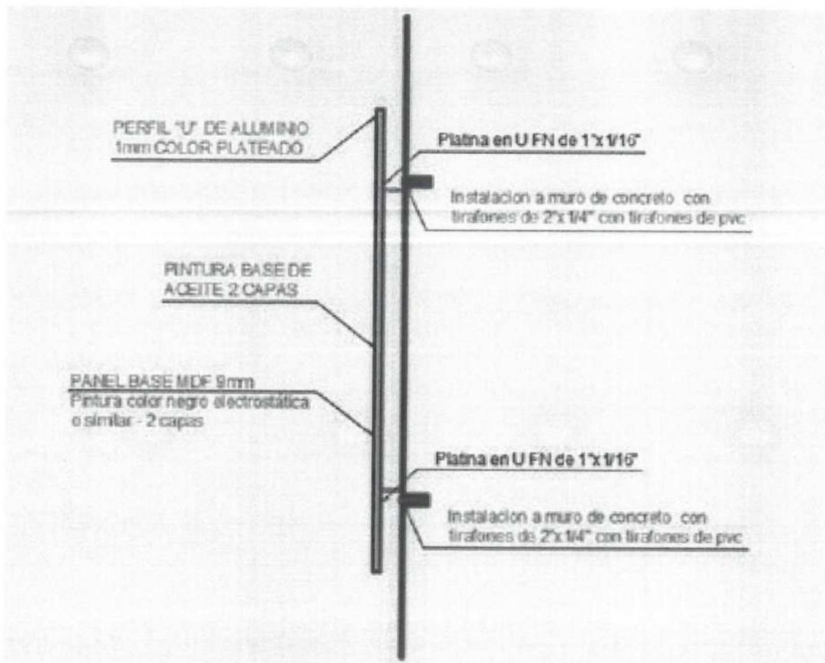
**DETALLE DE ANCLAJE EN EL MURO
